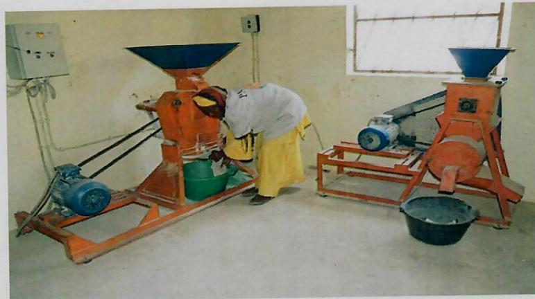
Décortiqueuse et broyeur à céréales fonctionnant simultanément grâce à l'énergie du moteur alternateur
