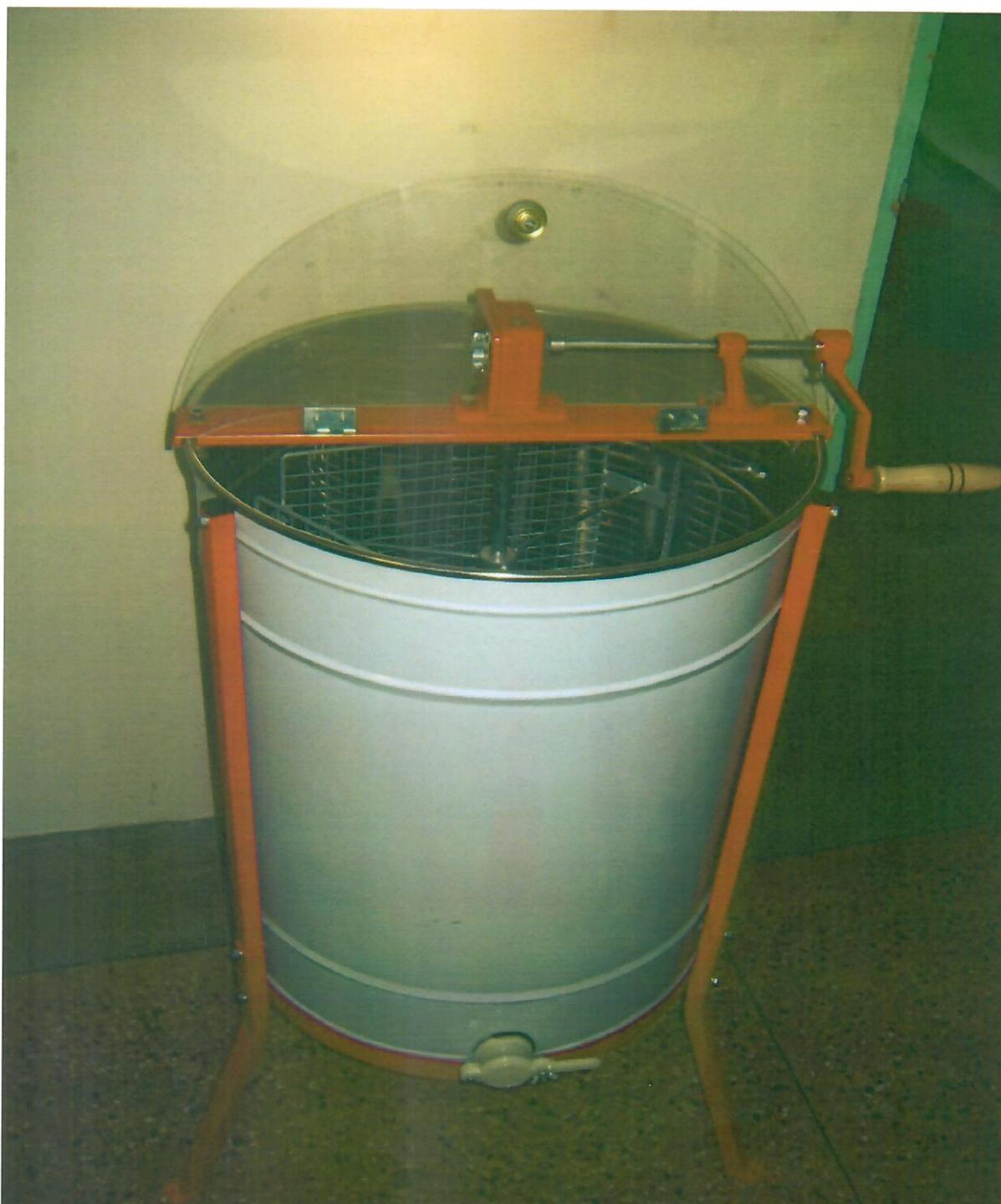
Fig. 2. Centrifugeuse Manuel.
